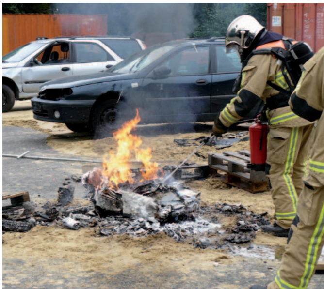
Bij de opengeknijpte accu blijkt het lastig om met waterglas de accu hermetisch af te sluiten. Hierdoor laait het vuur nog een keer opnieuw op.
