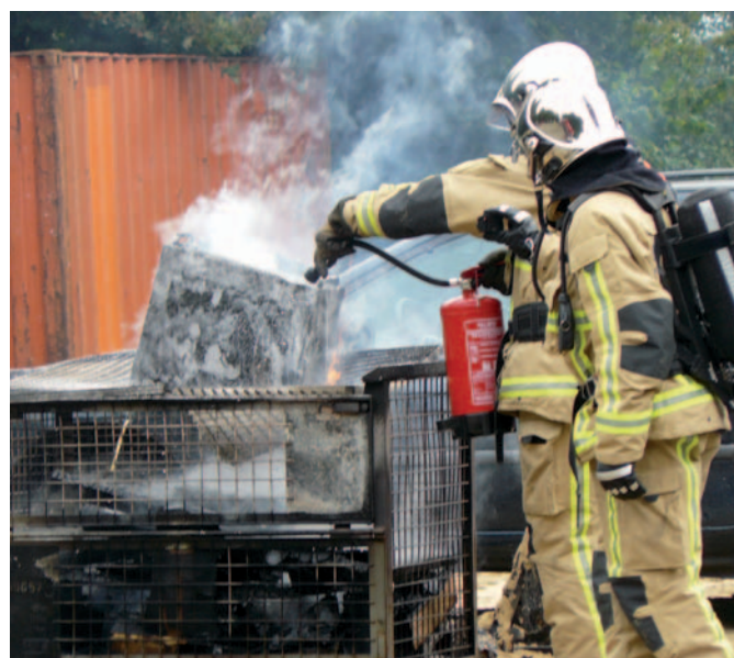
Na het opbrengen van het waterglas op de hele accu zijn bij de tweede test de vlammen direct weg en daalt de temperatuur snel
