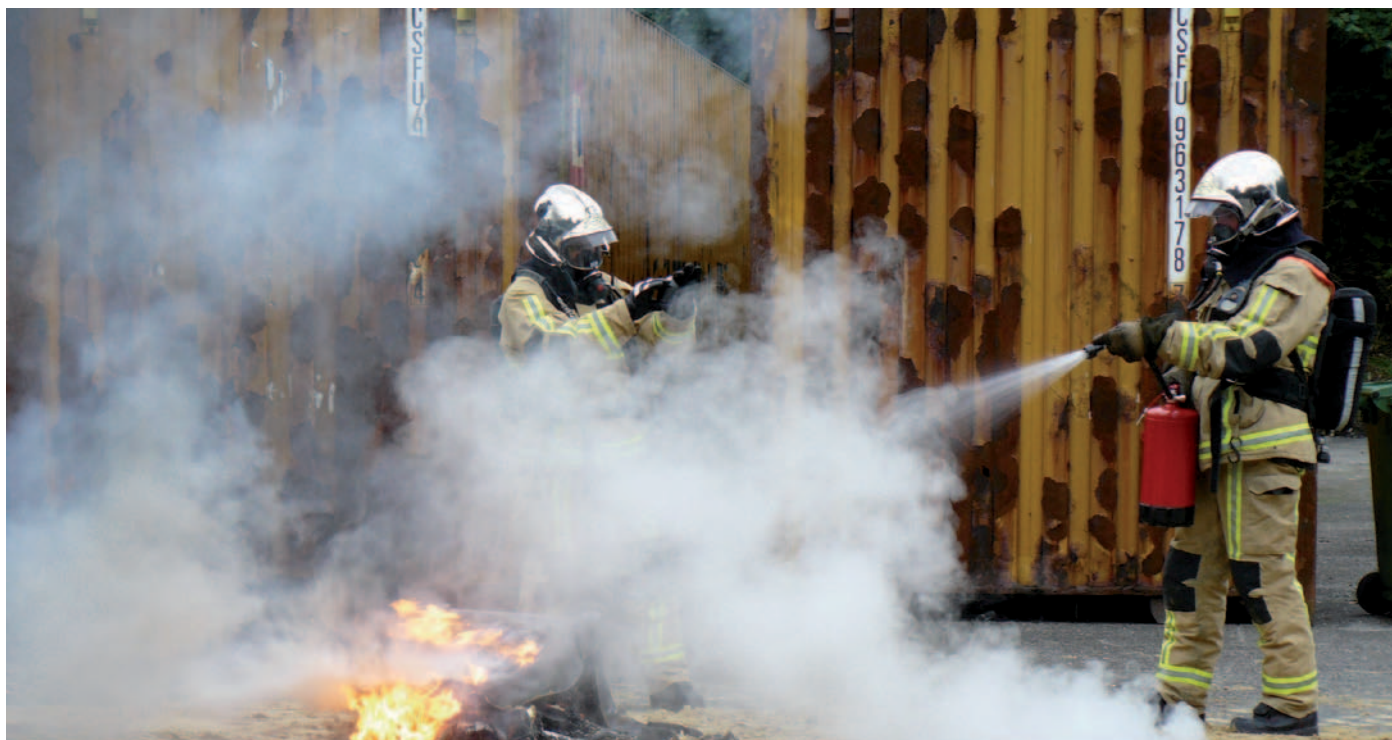
In de eerste testbranden onderzoekt Peter Butter van Brandweer Amsterdam-Amstelland met welke nozzle hij het waterglas het best kan opbrengen.
